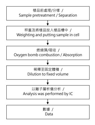
鹵素分析流程圖 / Analytical flow chart - Halogen
