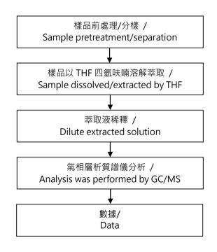
【測試方法/Test method: IEC 62321-8】
